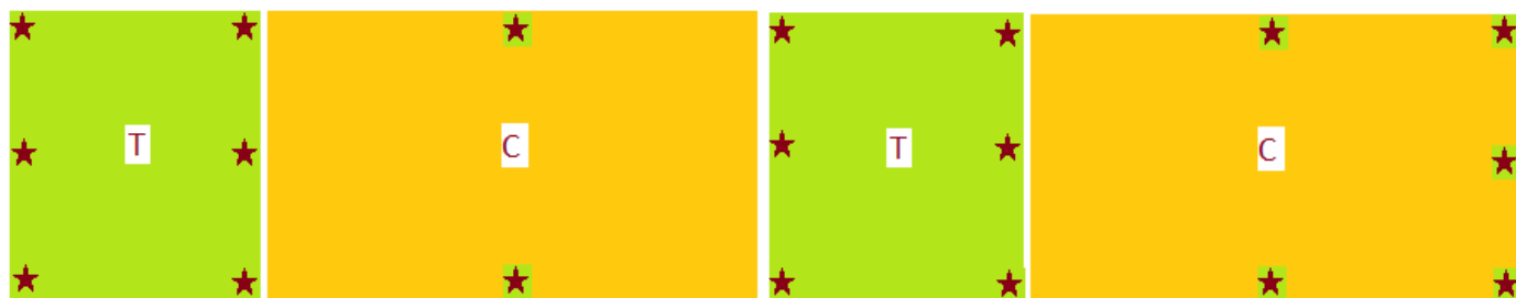
Schéma d'assemblage et de positionnement des 19 nouettes. Chaque étoile représente une nouette
